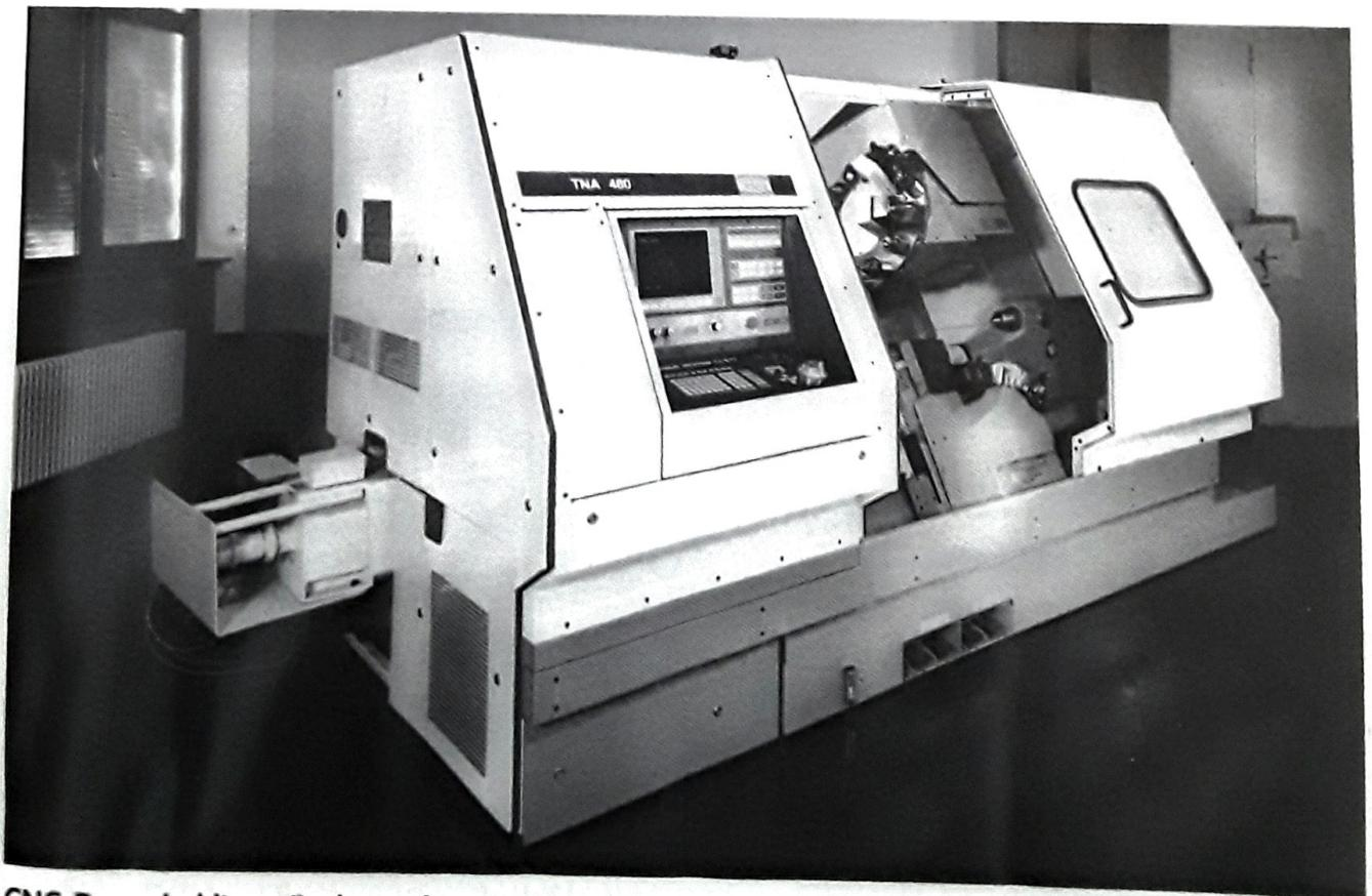
CNC-Doppelschlitten-Drehmaschine TNA 480 D
