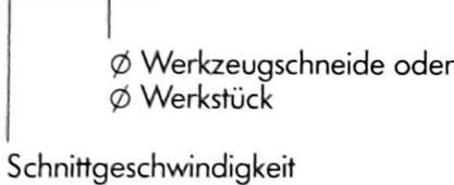
Mit der Anweisung G 97 und den Adreßbuchstaben V und X wird **indirekt eine feste Drehzahl** eingegeben. Die Eingabe einer Schnittgeschwindigkeit V und eines Werkstückdurchmessers X bewirkt, daß die Steuerung automatisch die dafür notwendige Drehzahl aus der Formel
