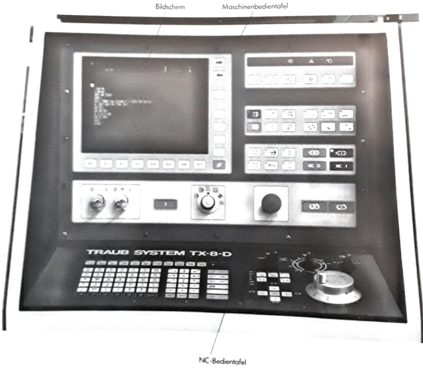
An der **Maschinenbedientafel** werden die verschiedenen Betriebszustände der Maschine ein- und ausgeschaltet. Erst dadurch können die gewünschten Maschinenfunktionen über das NC-Programm bzw. durch Handbetrieb in Gang gesetzt werden.
